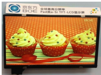
10.1" 300 ppi a-Si TFT-LCD
